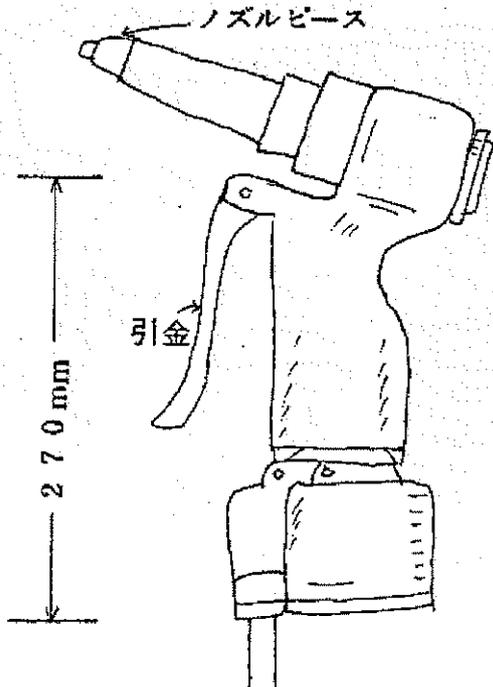
ノズルピースにリベットを挿入し、タッチでリベットがかしめられる。
